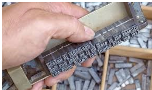
Illustration 5. Composteur utilisé par le typographe lors de la composition. Archives de l'auteur.
