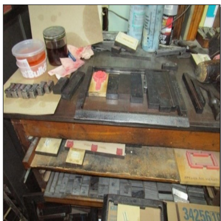
Illustration 4. Marbre sur lequel la forme est déposée dans un châssis avant l'impression sur presse. Archives de l'auteur.
